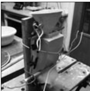
Réalisation d'un tirage en résine acrylique dans une empreinte de tétrahydre en élastomère. Phase de la coulée.
